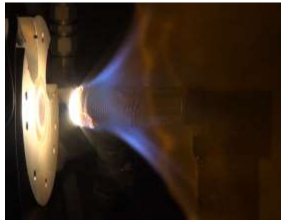
再突入カプセル用耐熱材料の風洞試験の様子
